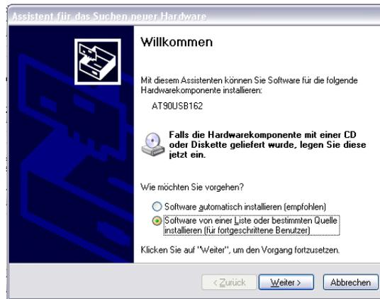
Mit der Installation von FLIP wurden gleichsam die benötigten Gerätetreiber für das *AT90USB Plug* ins Programmverzeichnis entpackt. Entsprechend muss Windows dieser Pfad mitgeteilt werden.
