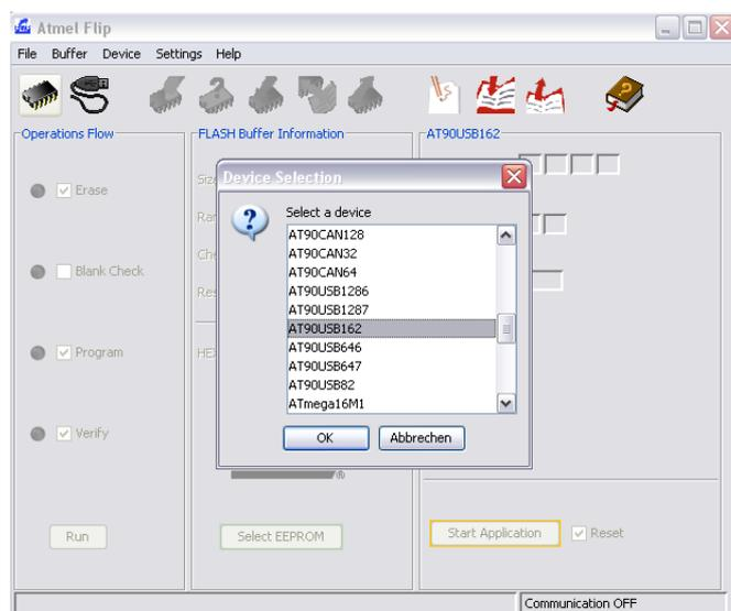
Nachdem die Einstellung vorgenommen wurde, kann das zweite Symbol angeklickt werden. Es folgt die Auswahl der Verbindung per USB. FLIP meldet sich mit der Aufforderung, eine Verbindung zu öffnen:
