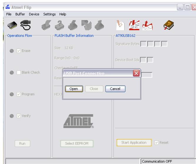
Nun sollten sich verschiedene Interaktionsmöglichkeiten mit dem Mikrocontroller eröffnen. Zum Test kann „Blank Check“ ausgewählt werden. Einem Klick auf RUN sollte die Information Blank Check PASS in der Statuszeile im unteren Fensterbereich folgen.
